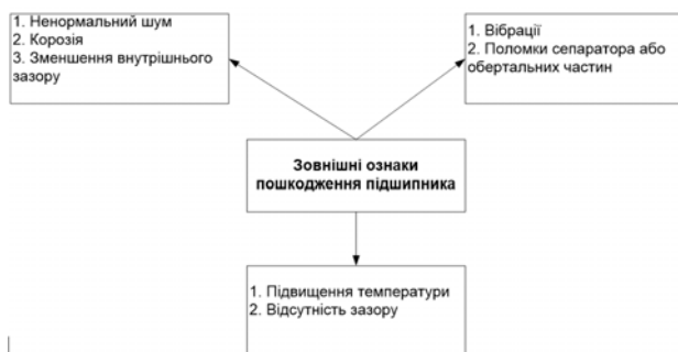
Рис. 4. Схема зовнішніх ознак пошкодження підшипника кочення
