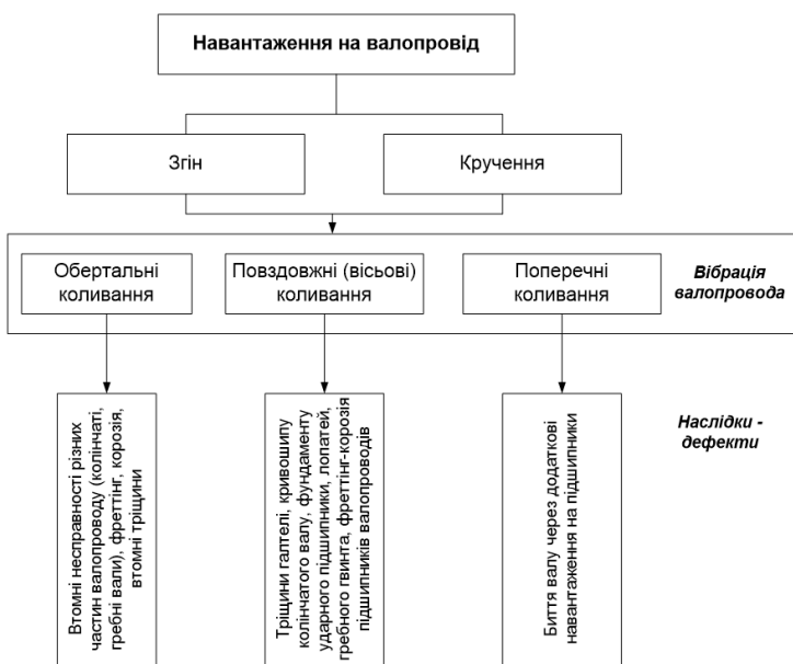
Рис. 2. Систематизація навантажень і дефектів валопроводу
